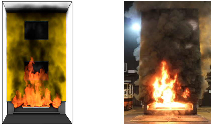
Kuva 8. Vertailurakenteen simulointimallin liekkien ja savukaasujen visualisointi sekä tämän vertailu polttokokeesta [6] otettuun valokuvaan.
